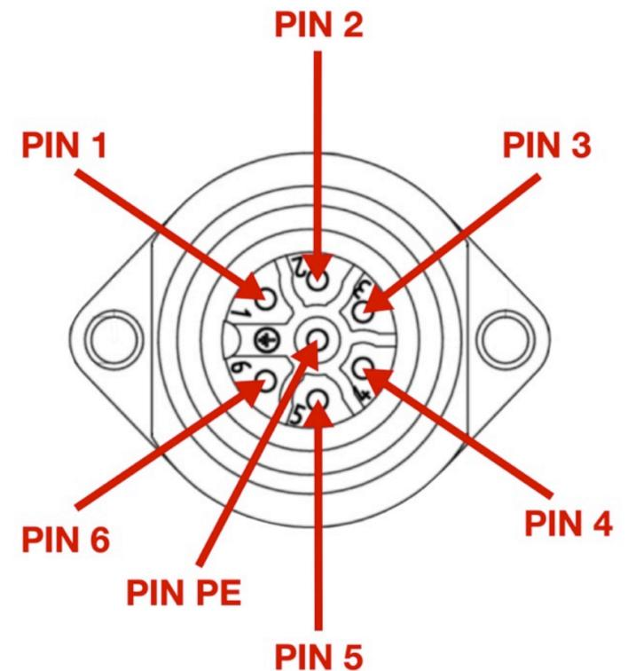
Beachten Sie **IMMER** die Kontaktbeschriftung auf der jeweiligen Verbindungsstelle!!! Die PIN Nummer befindet sich neben der entsprechenden Buchse / des Pins.
